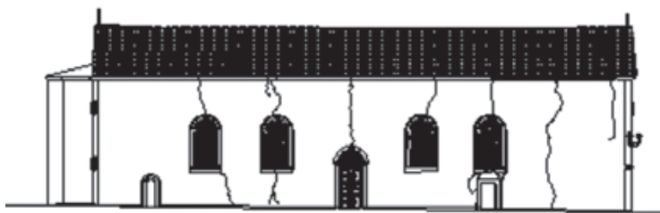
Σχήμα 5. Κατακόρυφες ρηγματώσεις των δύο επιμήκων τοιχοδομών.
