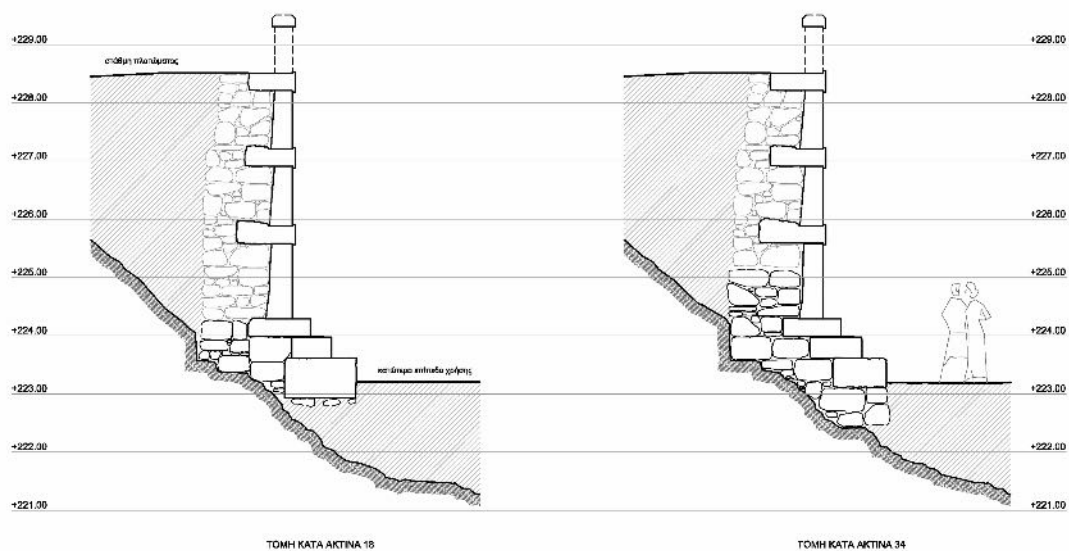
Εικ. 2. Υποθετική τομή/δομική αναπαράσταση του μνημείου (σχ. Γ. Ορεστίδης).
