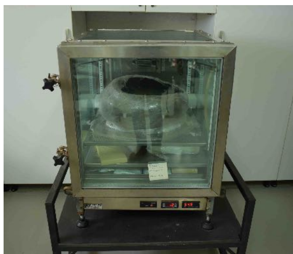
Εικ. 9. Θάλαμος ανοξικών συνθηκών παρουσία αζώτου (φωτ. ΕΦΑΚΟΡ).
